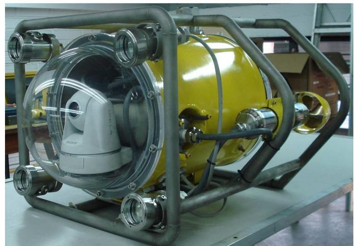
FIGURE 17. ROV FINAL ASSEMBLY
