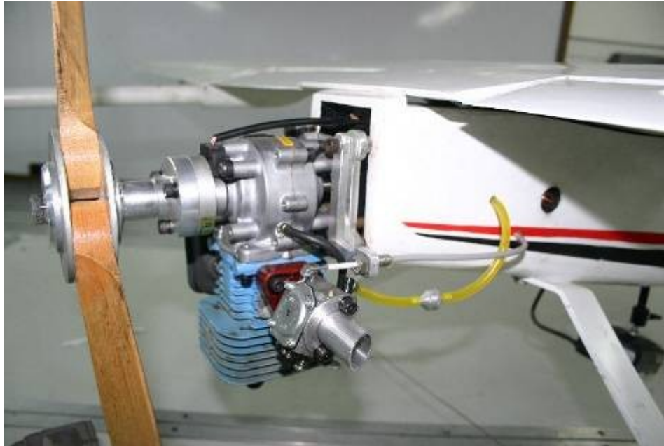
Instalación del nuevo motor
